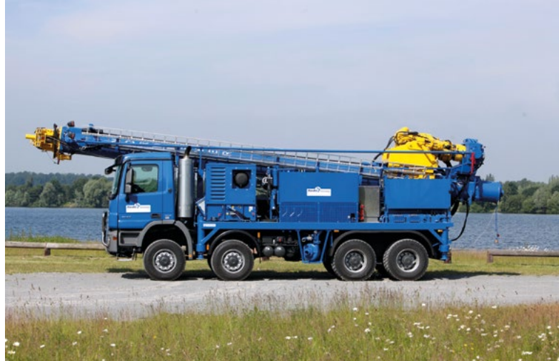
Abb. 6 DSB 5/50, bis Bohrtiefen von 1500m.
