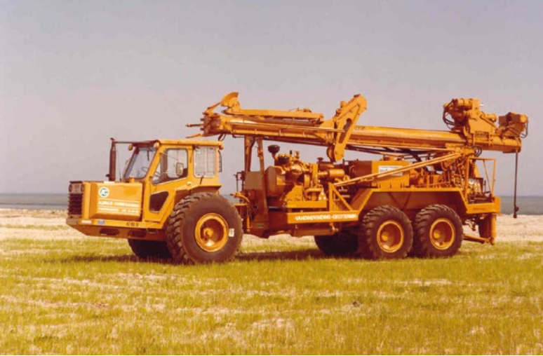
Abb. 1 Ein etwas anderes Dreh- und Schlagbohrgerät (DSB).
