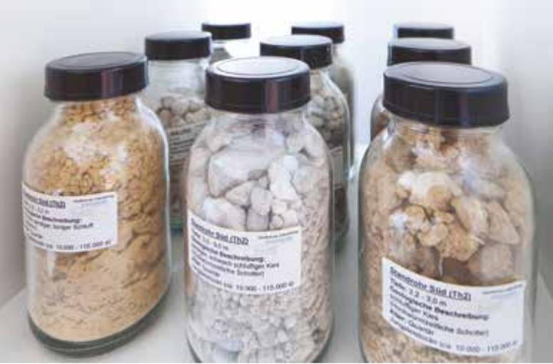
**Abb. 2** Jungpleistozäne Lockerablagerungen in Probengefäßen. Abhängig von den Sedimenteigenschaften wird die oberflächennahe Geothermieanlage ausgelegt.
