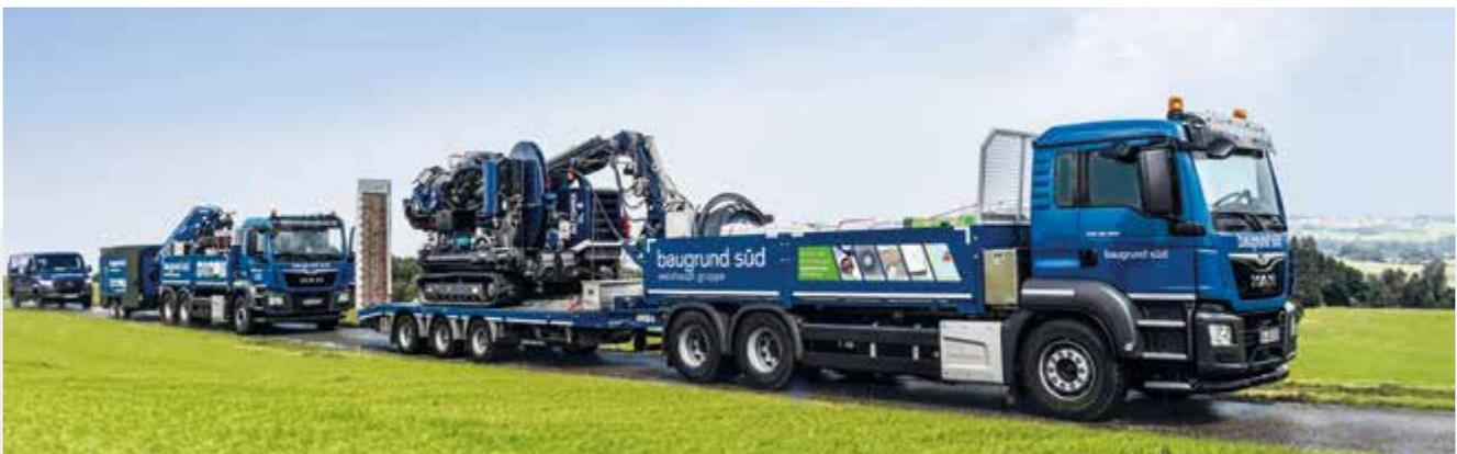
Abb. 1 Eine Bohrkolonne von BauGrund Süd mit Bohrgert, Material-LKW inkl. Kompressor und einem Service-Fahrzeug.
