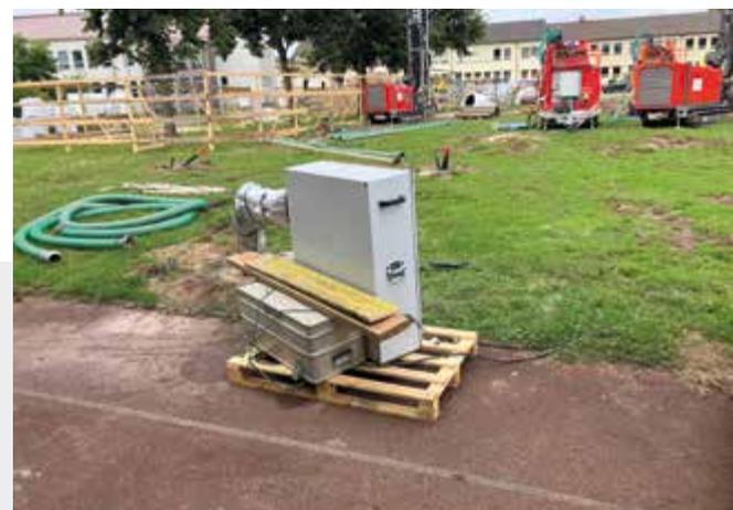
Abb. 14 Thermal-Response-Test an der ersten Bohrung
