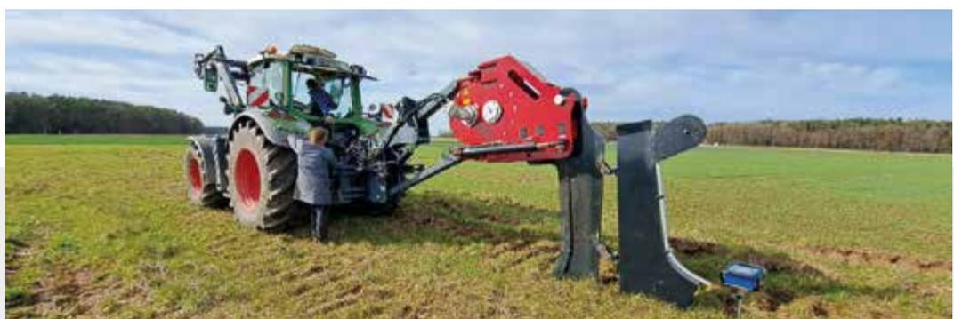
Abb. 4 Feldtest des Vibrations-Anbaupflugs. Foto: FAU
