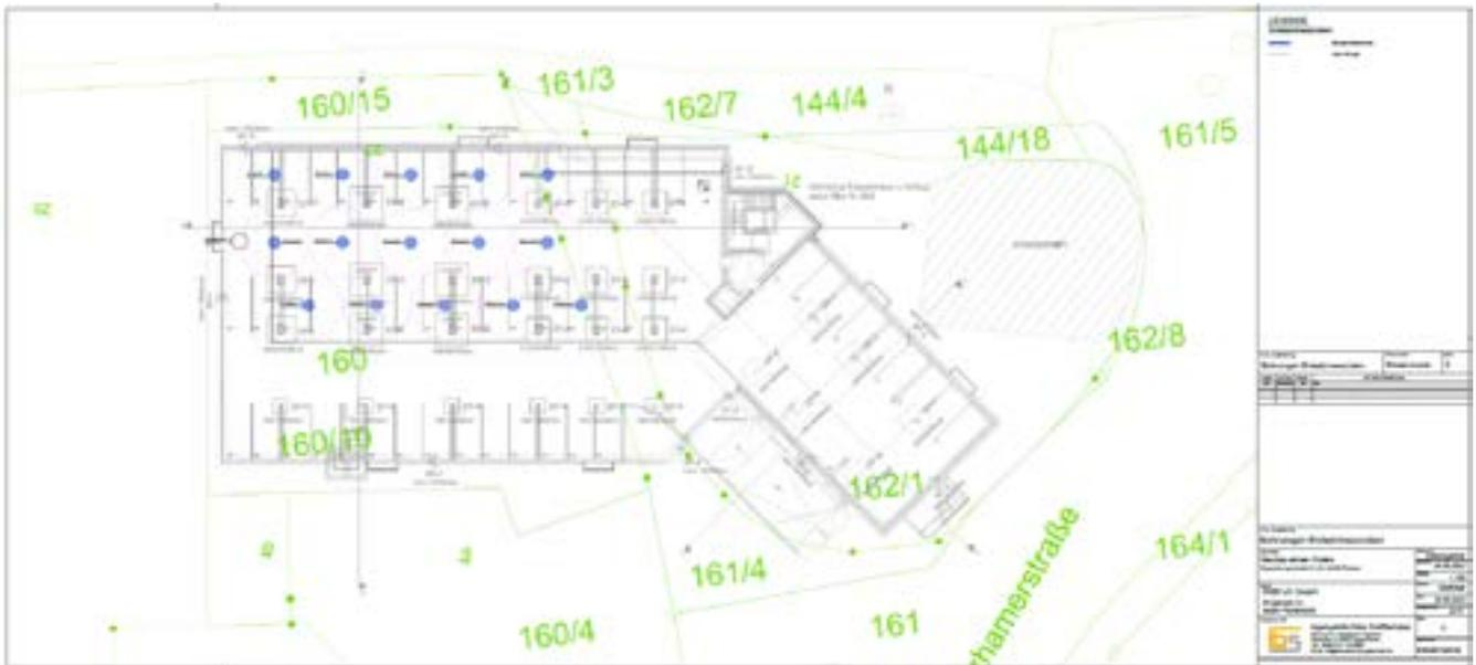
Gebäudegrundriss mit den eingezeichneten Bohrungen und der Lage des Verteilers für den Neubau des Hotels in Passau.
