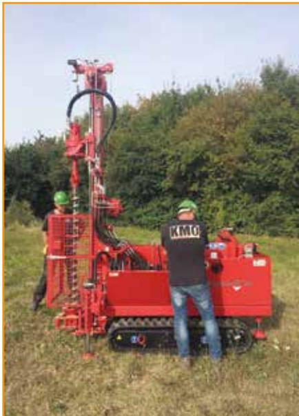
*Kompaktes Bohrgerät zur Kampfmittelerkundung.*
