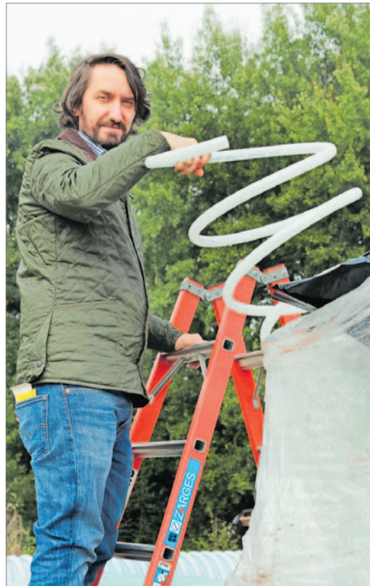
Projektleiter David Bertermann zieht einen der spiralförmigen Wärmekollektoren aus der Erde.
