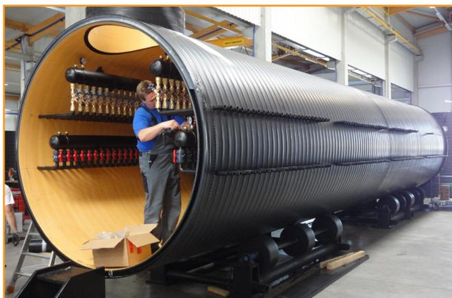
Der größte Verteilerschacht der Firma FRANK aus PE-Wickelrohr
