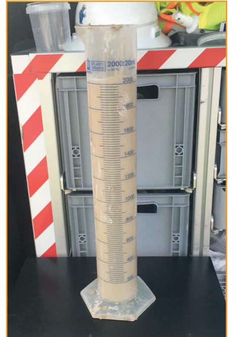
Ein weiterer Baustellentest ist das testen des Absetzverhaltens. Hier wird die Aufnahme des Wassers im Baustoff getestet. Als sehr gut kann man Werte <2% betrachten. Quelle: Fischer Spezialbaustoffe GmbH
